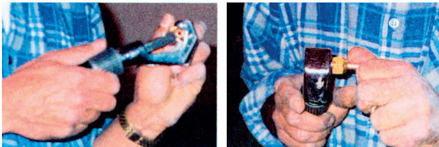
Εικόνα 6.6: Εκτόνωση και εκχείλωση των χαλκοσωλήνων.
