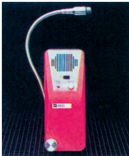
Σχήμα 5.3 Ηλεκτρονικός ανιχνευτής διαρροών για χλωροφθοράνθρακες (cfc's).
