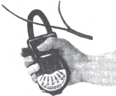
Σχήμα 13.3 Μέτρηση της έντασης με αμπεροτσιμπίδα σε μονοφασική γραμμή μονάδας κλιματισμού
